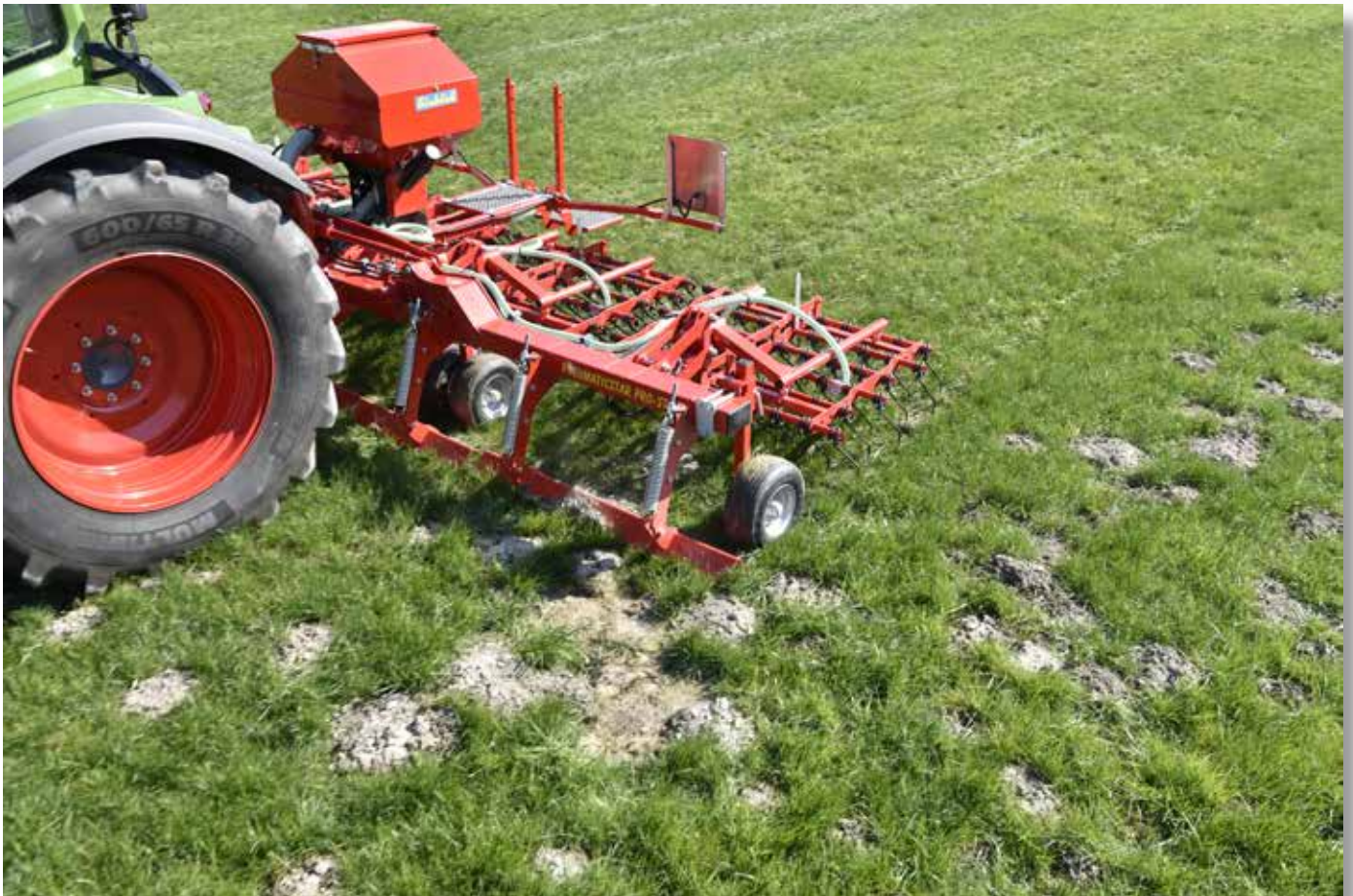
Gut geführter Bestand mit geringem Anteil an Gemeiner Rispe. Bei der Frühjahrspflege wird in einer Überfahrt die Grasarbe belüftet, Maulwurfshügel eingeebnet und Saatgut nachgesät.
