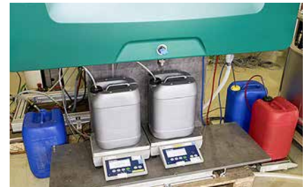
Die Verbräuche an Peressigsäure, Dipp- und Reinigungsmittel wurden mitgeschrieben.
