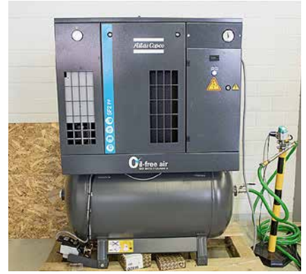
Der Druckluftkompressor Atlas Copco SF22 erreicht eine Nennleistung von 2,2 kW.
